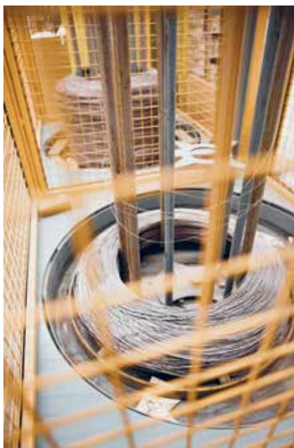
Galvanoitu teraslanka taivutetaan sängynjousiksi. Vesa Tuominen on intohimoinen hyvän unen puolestapuhuja.
